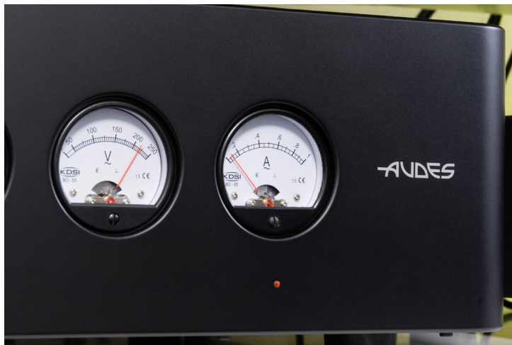
Die rechte Anzeige ist ebenfalls ein Amperemeter. Es zeigt den momentanen Stromfluss durch den Transformator und die Steckdosen der Gruppe 2 an. Diese Steckdosen-Gruppe ist abschaltbar. Ob sie aktiviert oder deaktiviert ist, indiziert die zugehörige LED. Das Amperemeter ist, wie auch die beiden anderen Anzeigen, nicht beleuchtet. Eine Illumination der Instrumente bietet allein das Flaggschiff von Audez, der DT-3600 DC.
