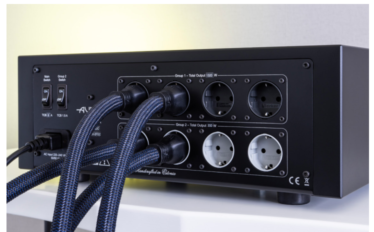
Der Power Conditioner sollte mit qualitativ angemessenen Netzkabeln betrieben werden. Wir haben im Test durchweg das Audioquest Monsoon eingesetzt. Wie herum man den Netzstecker der anzuschließenden Komponenten einsteckt, ist egal: Dank der symmetrischen Spannung, die die Trafos des TT-1700 DC sekundärseitig erzeugen, sind die Potenzialausgleichsströme per se minimiert. Eine Kenntlichmachung der Phase oder ein Ausphasen der Audiokomponenten ist somit nicht nötig.
